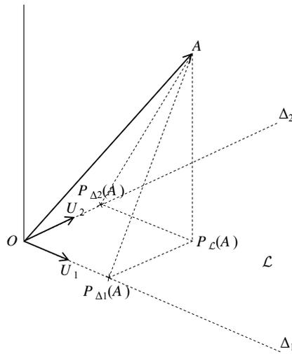
FIG. 5.7 – Projection orthogonale d'un point sur un plan
