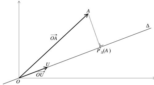
FIG. 5.5 – Projection orthogonale du point  $A$  sur la droite  $\Delta$
